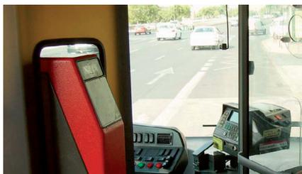
Ilustración 7: Dispositivo RFID en transporte público
