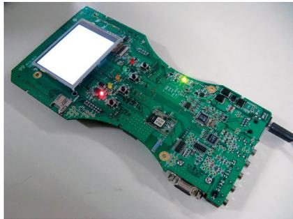
*Ilustración 20: Prototipo de Firewall RFID*
